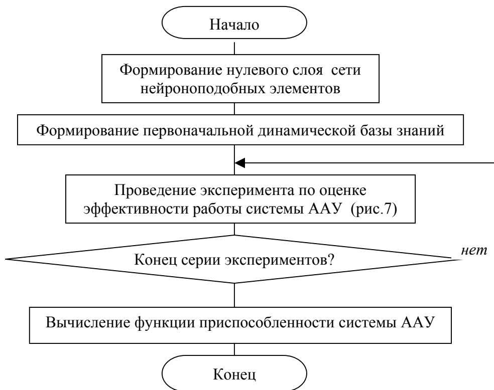
Рис. 8. Схема расчетов для определения показателя эффективности системы управления.
