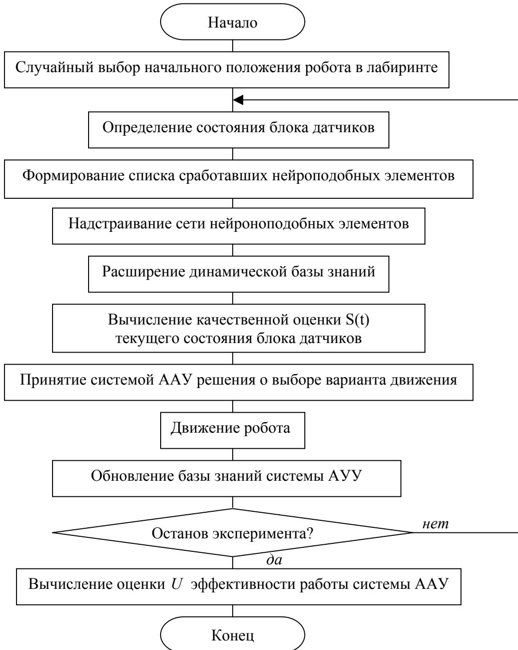
Рис. 7. Алгоритм оценки эффективности работы системы ААУ при движении робота в лабиринте.
