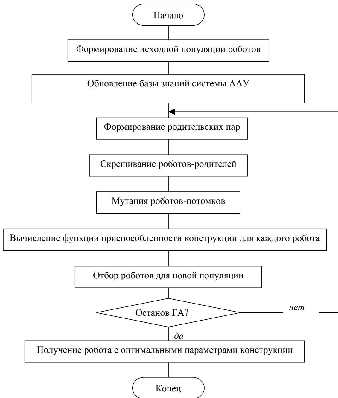
Рис. 4. Общая схема оптимизации с помощью генетического алгоритма.
